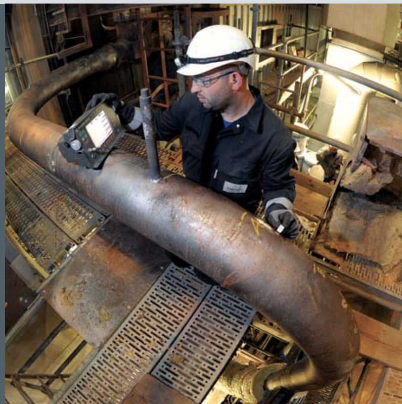
Wanddickenmessung mittels Ultraschall an einer Rohrleitung (Foto: Andreas Seidel, Chemnitz)
