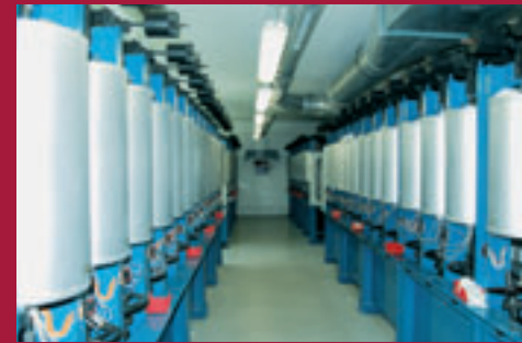
Blick in ein Zeitstandlabor mit Einzelofenanlagen
